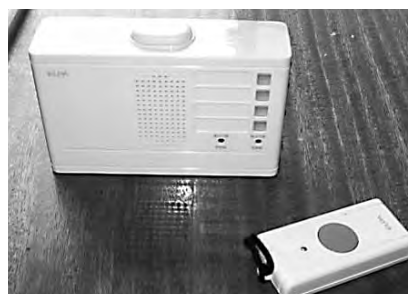
写真3：電気式簡易呼び出しベル
